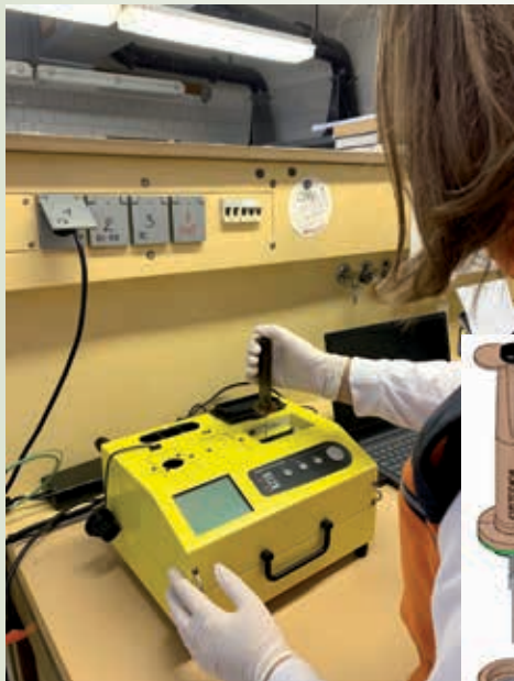
Nástrek vzorky na GC-MS Torión v laboratóriu KCHL CO v Nitre. Obrázok externého modulu SPS-3 s pumpou v KCHL CO v Nitre pre odber vzoriek vzduchu so zakoncentrovaním nečistôt
